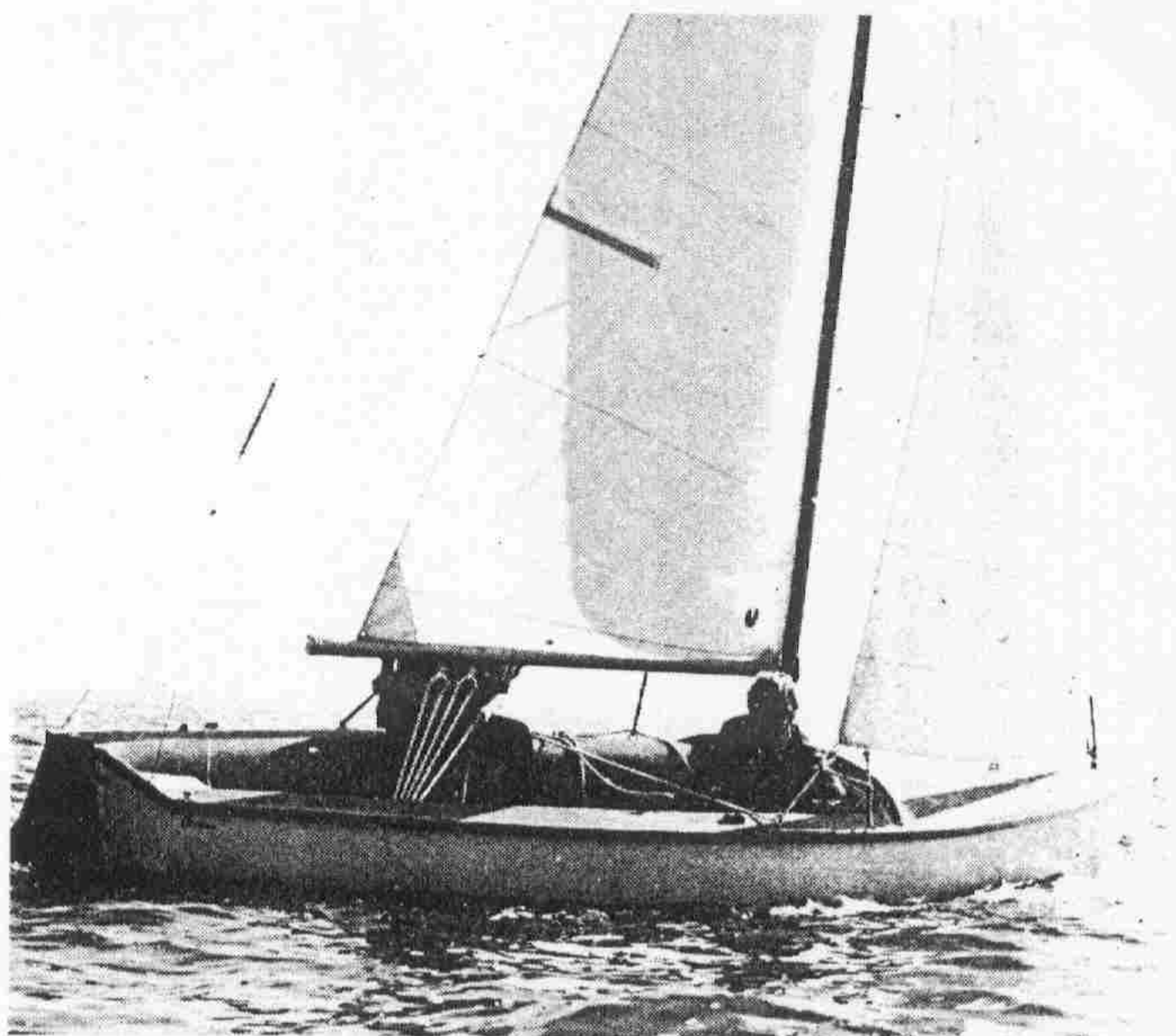
De Varuna 500; vol grootspant, forse kimmeneens schraal achterschip
