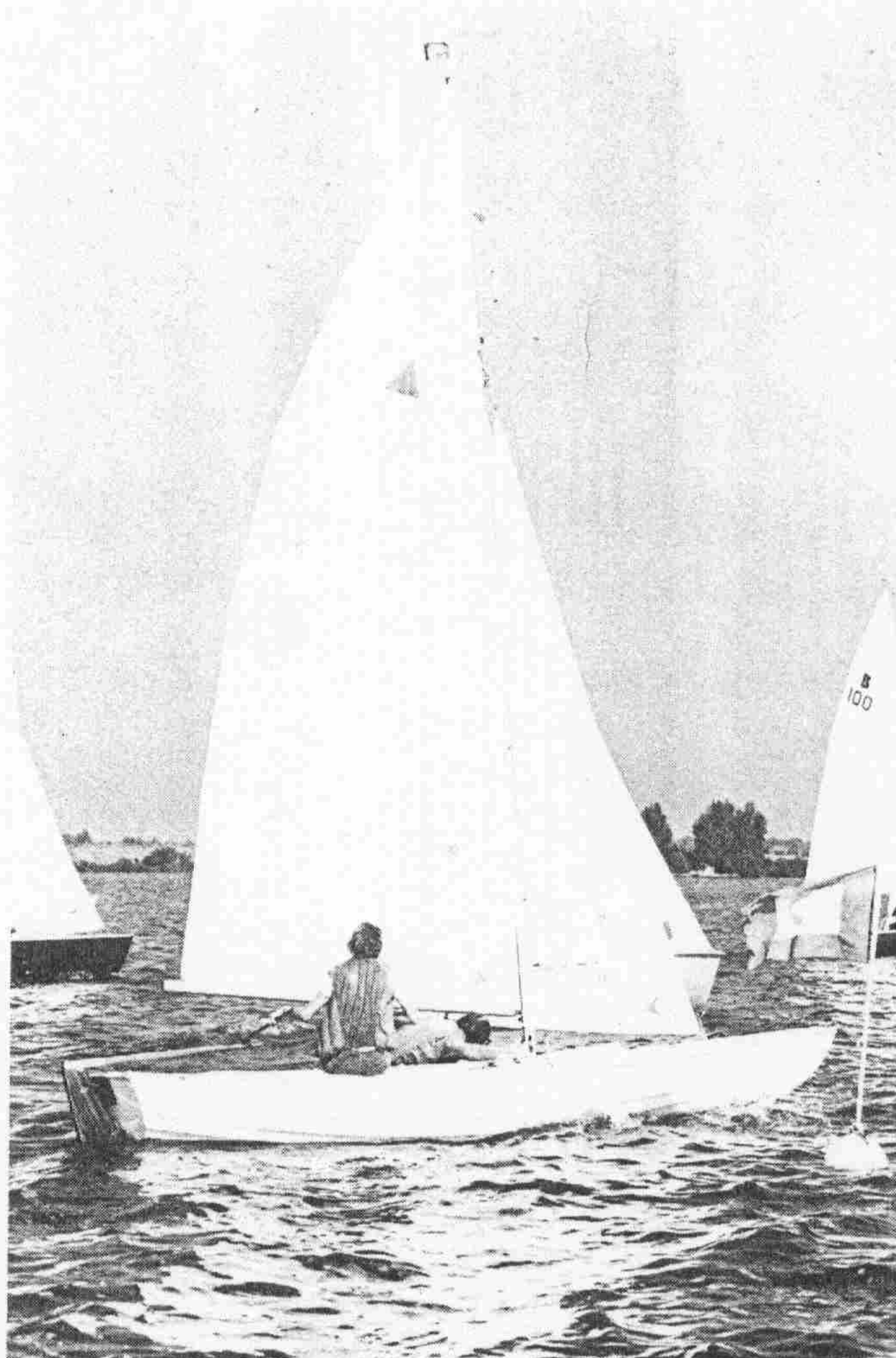
Kenmerkend voor de Oslo jol zijn de geringe breedte en grote overhangen
