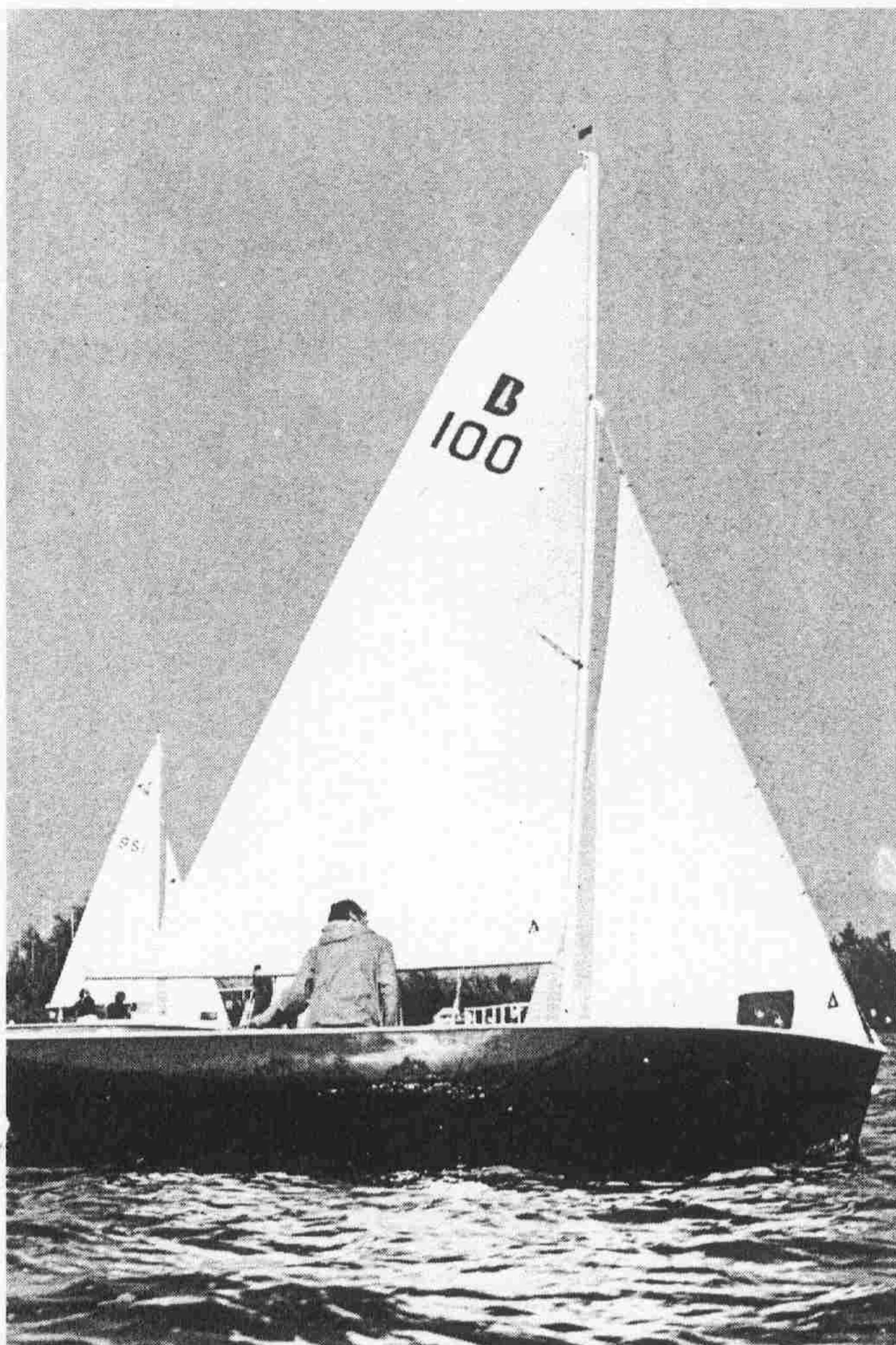
Op deze foto valt duidelijk de rechte steven en het volle voorschip van de Barnegat op
