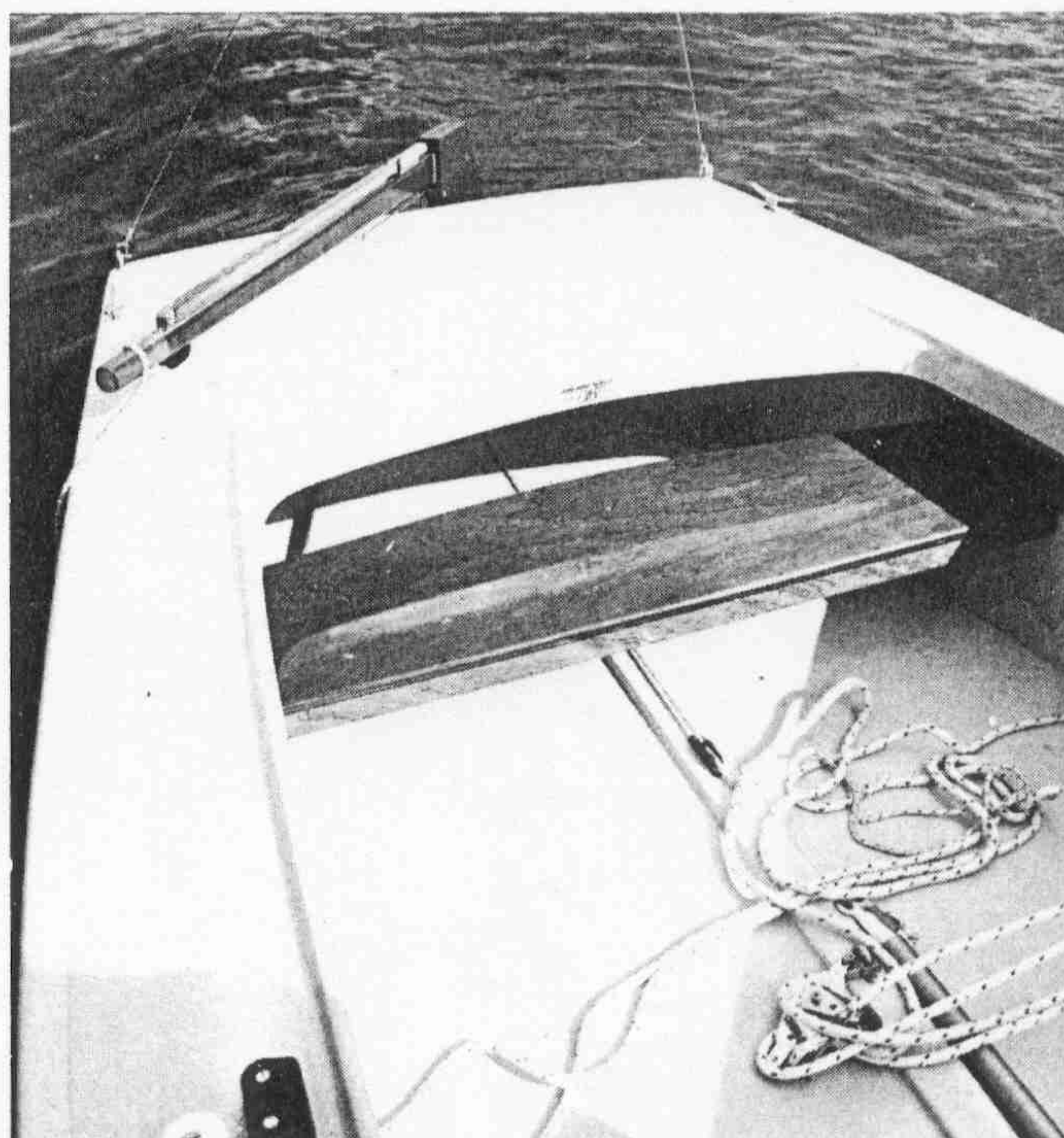
Het houten bankje in de kuip van de Bruiser is te ver naar achteren geplaatst
